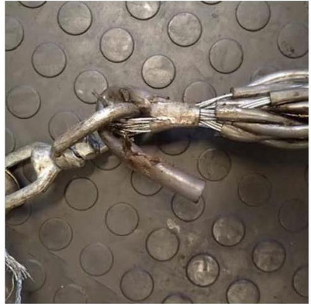
Componentes que fallaron en el sujetador del cable
