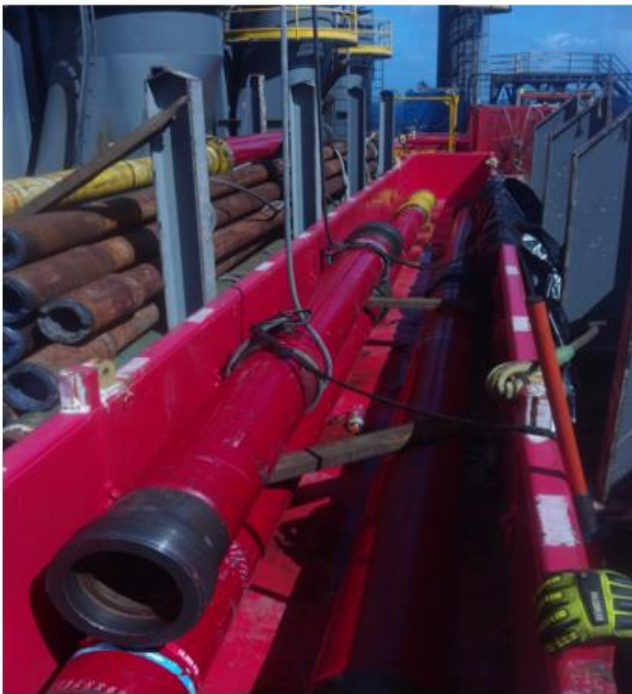
Posición inicial de los conductores (risers)
