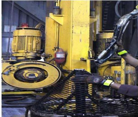
El Canasto Para Personal con el Tubo de Levantamiento Partido
