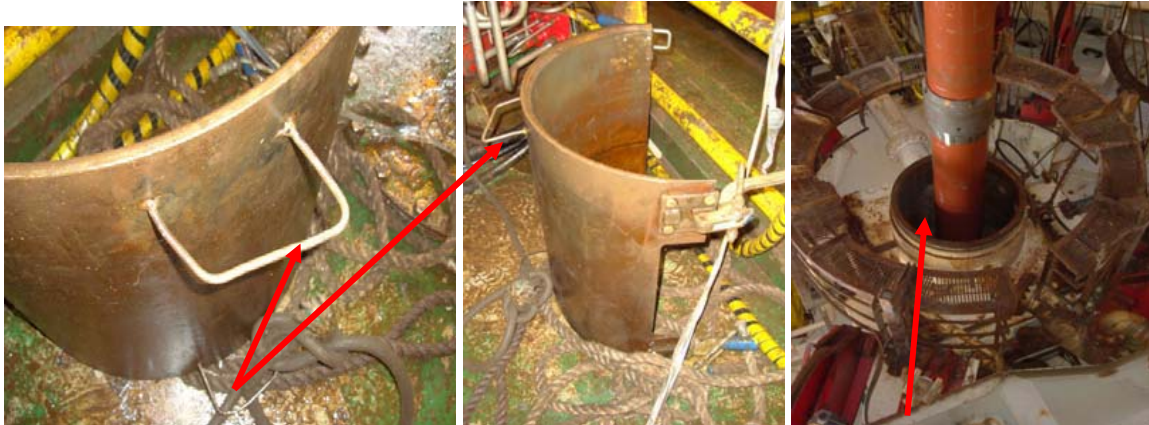
La manija de levantamiento donde se fijó el cable.
