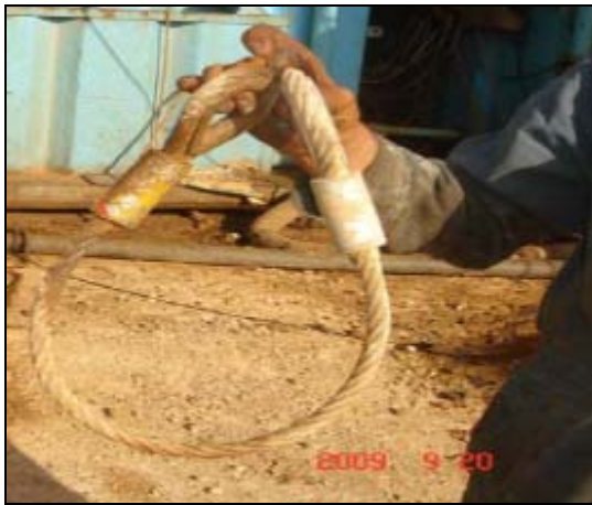
Eslinga de cable de acero que cayó al piso de perforación.
