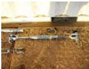
Perno para aparejo incorrecto que cayó
