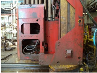
Ensamble de llave de tuberías automática – Carro Interno Extendido.
