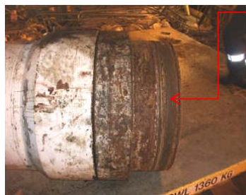
El estado de la rosca del desviador partido
