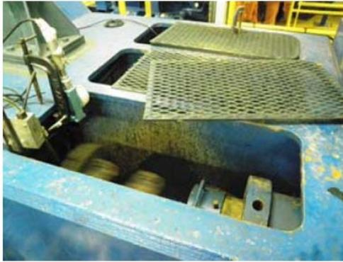
Tapa Protectora del Vástago Pulido apoyado sobre la parte superior de la bomba.
