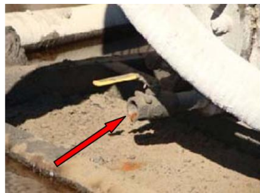
Figura 5: Luego de la distribución de la emisión inicial de este alerta de seguridad en toda la flota, la bomba fue corregida quitando el tapón ciego e instalando una palanca nueva en la válvula de bola.
