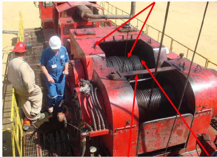
Posición del segundo individuo (un pie sobre el tambor del cable de la cuchara y un pie sobre un soporte en la carcasa del malacate principal).
