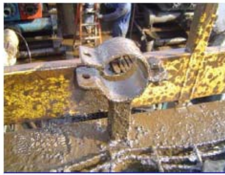
Soporte de anclaje del Tanque de Lodo luego del incidente. Observar que el pasamanos también fue quitado en el momento del incidente.
