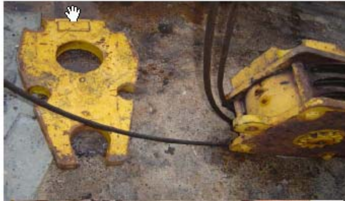
Soldadura vieja desgastada
